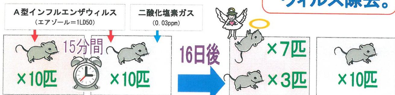
A型インフルエンザウイルスと同時に二酸化塩素ガス、または空気を15分間暴露、それぞれ10匹のマウスの死亡率を比較。
